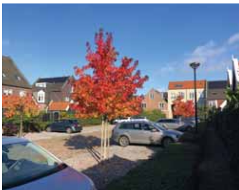
Parkeerplaatsen in halfverharding om waterinfiltratie te bevorderen
